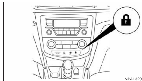
Témoin de verrouillage électrique de portière
